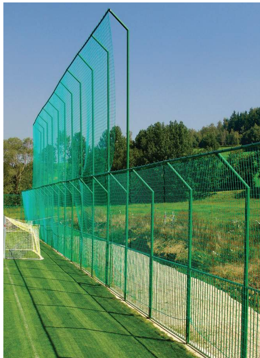
Backstop-nett brukes til fotball- og håndballbane gjerder og skillenett for sportsanlegg. Materiale PP; maskestørrelse 120mm, nettykkelse 3, 4 eller 5mm, farge: grønn, hvit, fargestriper: grønn-hvit, blå-hvit, grønn-gul, blå-gul
